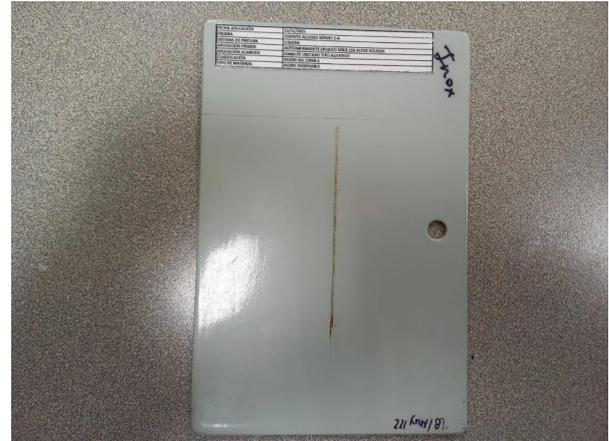
Probeta en Acero Inoxidable pintada en Liquida
