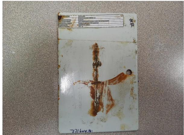
Probeta en Acero HR pintada en Liquida
