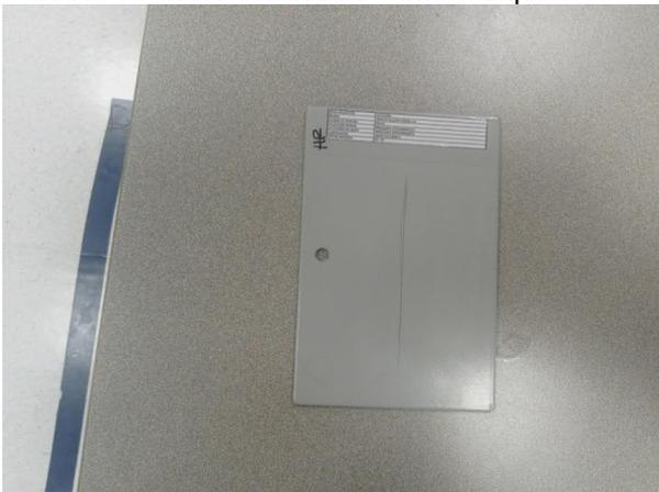
Probeta en acero HR pintada en Liquida
