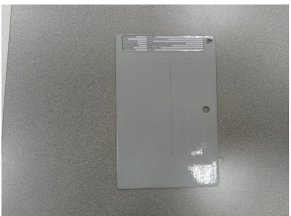
Probeta en aluminio pintada en Liquida
